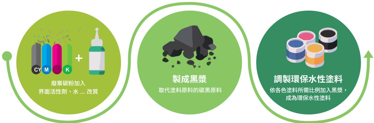
研發廢棄碳粉的新回收機制與應用，取代塗料原料碳黑 (註 1)、調製為黑漿 (註 2)，塗料廠商再將黑漿調製為各種顏色的水性塗料。所製成的水性塗料符合台灣 CNS4940 水性水泥漆 (乳膠漆) 規範。
